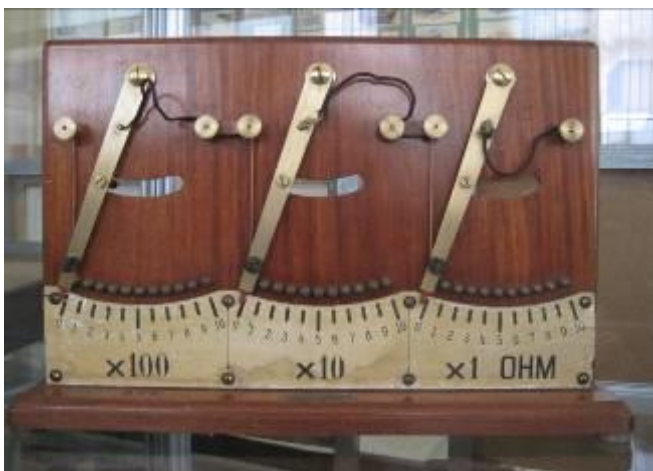
Магазин сопротивлений - прибор для кратковременного введения в электрическую цепь различных сопротивлений определенной величины при изучении законов электрического тока. Фото 2010 г.
