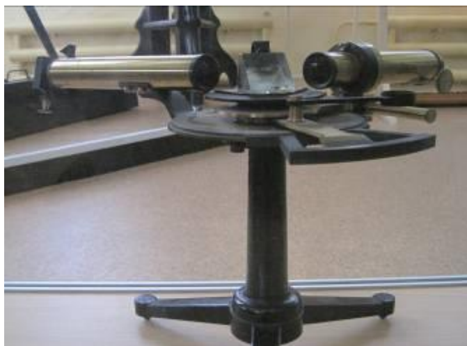
Двухтрубный спектроскоп - прибор для исследования спектров, определения длины световых волн, спектральных линий, паров металлов, наблюдения сплошного спектра при измерении температуры накала светящихся тел. Фото 2010 г.
